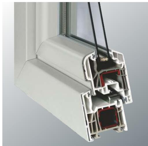
Zeitgemäßes Fenster mit eckigem Rahmen und rundem Flügel und 2 Dichtungen mit Alu-Schalen außen. Alternativ mit Design Glasleiste.
